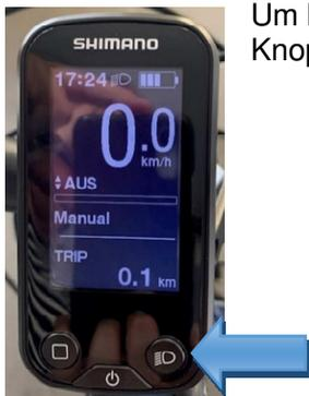
Um bei Ihrem Elektrofahrrad das Licht ein- bzw. auszuschalten, halten Sie den Knopf rechts unten auf dem Display gedrückt, bis das Licht an- bzw. ausgeht.
