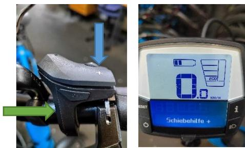
Drücken Sie auf den Walk-Button (grüner Pfeil) bis auf dem Display Schiebehilfe angezeigt wird. Drücken Sie gleich danach die + Taste (blauer Pfeil) und halten Sie diese um die Schiebehilfe zu aktivieren. Sobald Sie die Taste + loslassen, bremsen, das Rad blockiert (Hindernis) oder 6 km/h überschritten wird, deaktiviert sich die Schiebehilfe automatisch.
