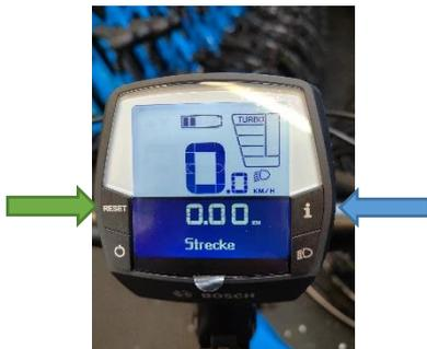
Drücken Sie **i** bis zum Menüpunkt Strecke und halten Sie **Reset** ca. 3 Sekunden gedrückt bis der Kilometerstand 0 anzeigt. Die Menüpunkte Maximal, Fahrzeit & Durchschnitt können Sie auf dieselbe Weise ebenfalls mit Halten der **Reset-Taste** zurücksetzen.
